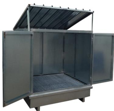
**Gli armadi con vasca di contenimento** permettono di stoccare fusti e cisternette anche in luoghi esterni. Sono dotati di una porta a doppia anta anteriore con serratura sul lato da 1500 mm. Sono realizzati in lamiera zincata con vasca di raccolta con altezza 500 mm e con capacità di 1000 litri e piano d'appoggio in grigliato. Dispongono di una copertura fissa oppure apribile.
