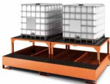
Le vasche di raccolta o contenimento con rialzo permettono, oltre al semplice stoccaggio, di poter spillare dai contenitori posizionati direttamente in recipienti più piccoli senza avere il pericolo di fuoriuscite di liquidi, se non all'interno delle vasche sottostanti. Sono realizzate in acciaio verniciato con grigliato d'appoggio superiore con maglie ad alta portata in acciaio zincato a caldo.
