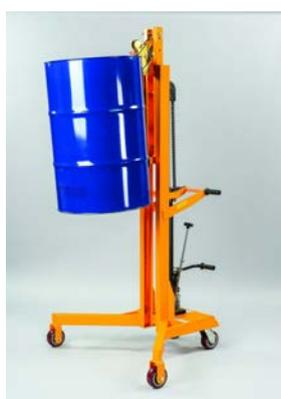
Il **sollevatore idraulico in acciaio verniciato a polvere** è adatto per il carico e lo scarico di fusti in acciaio da 210 litri. Questa versione ha una capacità di sollevamento extra elevata di 1,2 metri. La pompa idraulica è azionata a pedale e ogni carrello ha 2 ruote fisse e 2 ruote con freno.
