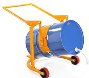
Il carrello manuale è adatto alla movimentazione e al ribaltamento di fusti da 210 lt. Permette un'alzata manuale del fusto da terra in modo pratico e maneggevole, grazie alla rotazione di 360° e al meccanismo a pistone.
