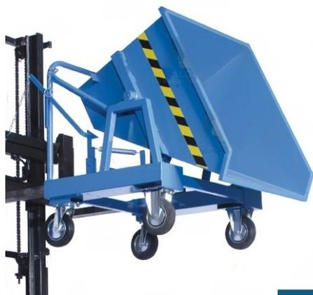
La **benna basculante ribaltabile** è costituita da lamiere e tubolari in acciaio. Gli ammortizzatori in gomma le permettono di attutire gli urti di rotazione e la vasca saldata a tenuta stagna impedisce lo scolo di liquidi durante la movimentazione. È composta da due ruote fisse e due girevoli, le quali permettono un'agevole movimentazione manuale. È utilizzabile per trasportare qualsiasi scarto di lavorazione.
