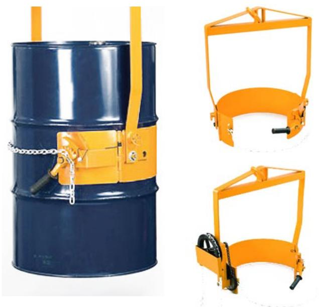
Il ribaltafusti permette di ruotare i fusti in ferro da 210 litri per travasare il liquido contenuto. È disponibile in due versioni: per gancio manuale oppure per gancio con movimentazione a catena.
