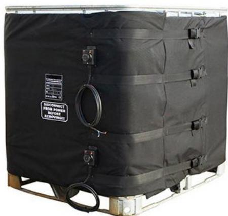
**La fascia scalda cisternette da 1000 lt** è utile per evitare il congelamento di liquidi in ambienti freddi e per ridurne la viscosità. È dotata di 2 termostati regolabili da 0/90°C, avendo 2 circuiti di riscaldamento indipendenti. Il cavo di alimentazione è lungo 3 metri, il tessuto interno è in teflon con isolamento in poliester e fibbie regolabili ad apertura rigida.
