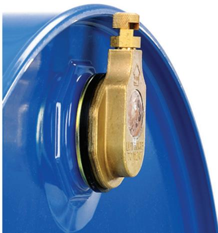
**Lo sfiato per fusti** ha lo scopo di scaricare le pressioni elevate dei gas che evaporano all'interno del fusto. L'apertura dello sfiato è automatica, ma può anche essere azionata manualmente. È realizzato in ottone.
