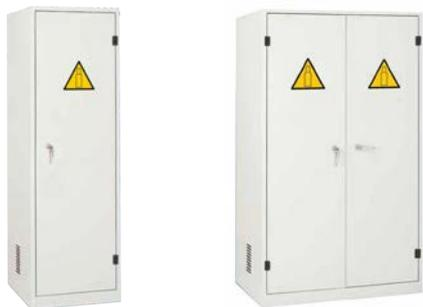
Gli armadi di sicurezza per lo stoccaggio di bombole gas per interni ed esterni sono realizzati in lamiera di acciaio elettrozincata FE P01 con spessore 15 - 10 mm pressopiegata a freddo e verniciata. Hanno una costruzione di tipo "monolitico" con alla base piedi per la messa a livello dell'armadio. Le porte ad ante cieche sono complete di maniglie con chiusura di sicurezza e serratura ed apertura a 110°. Sono completi di cartelli di sicurezza indicano la presenza di bombole di gas.
