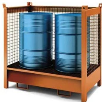
Le vasche di raccolta o contenimento con sponde laterali a rete permettono, oltre al semplice stoccaggio, di avere un'ulteriore sicurezza di anti ribaltamento dei contenitori anche in caso di spostamenti all'interno degli stabilimenti. Sono realizzate in acciaio verniciato con grigliato d'appoggio superiore con maglie ad alta portata in acciaio zincato a caldo.
