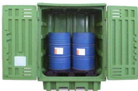
L'armadio in polietilene rigenerato con vasca di raccolta è ideale per lo stoccaggio in sicurezza di fusti e cisternette. È resistente ad acidi, basi e oli. Dispone di una chiusura a leva lucchettabile, di maniglie e di quattro grate di aerazione sulle ante.
