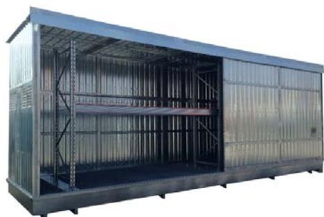
**Il container in lamiera grecata zincata** per lo stoccaggio di cisternette da 1000 litri dispone di vasca di contenimento interna. Le cisternette IBC possono essere posizionate sia in linea che sovrapposte, a seconda dello spazio disponibile. All'interno della struttura sono presenti delle scaffalature in acciaio zincato fissate al pavimento e regolabili in altezza.
