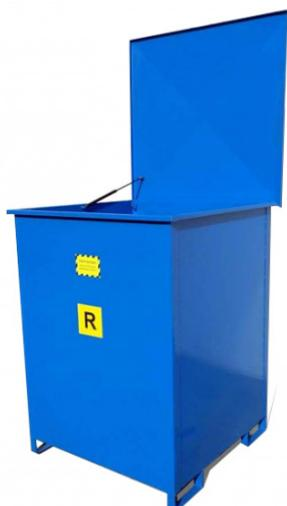
La **struttura porta Big Bag** chiusa con coperchio è ideale per lo stoccaggio dei sacconi all'esterno. Realizzata in acciaio galvanizzato, la struttura è disponibile in due versioni: con portellone superiore incernierato e servoassistito da due pistoni a gas oppure con coperchio removibile. Inoltre, può essere movimentata con transpallet.
