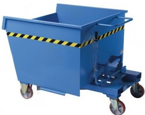
La **benna completamente ribaltabile** è realizzata con tubolari e lamiere d'acciaio con ruote in funzione della portata adatta ad essere affiancata a macchine operatrici quali torni, frese e presse. La vasca a tenuta stagna impedisce la fuoriuscita di liquidi. Le ruote montate su cuscinetti a sfera garantiscono una facile movimentazione e gli inforcamenti permettono una rotazione a 160° della benna con scarico totale del contenuto.
