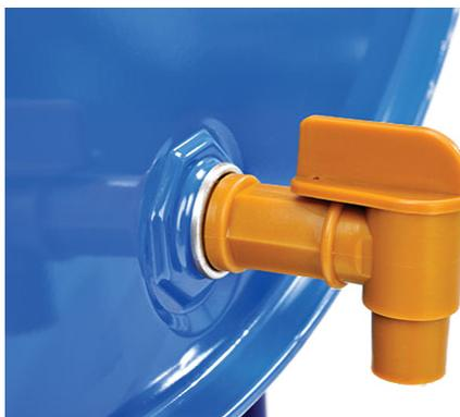
**Il rubinetto per fusti in polietilene** è disponibile in due versioni: con filettatura 3/4" (foto in basso) e con filettatura 2" (foto in alto). La prima versione non presenta guarnizioni, perciò è ottima per liquidi acidi. La seconda presenta guarnizioni in EPT ed è in grado di svuotare fusti da 210 lt in soli 3 minuti.
