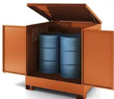
**Gli armadi con vasca di contenimento** permettono di stoccare fusti e cisternette anche in luoghi esterni. Sono dotati di griglie di aerazione laterali per il ricircolo dell'aria e di doppia anta anteriore per l'apertura e il posizionamento dei materiali. Sono in acciaio verniciato con grigliato d'appoggio con maglie ad alta portata in acciaio zincato a caldo. Su richiesta, l'armadio per lo stoccaggio di due fusti è disponibile con comodo ripiano scolafiltri.
