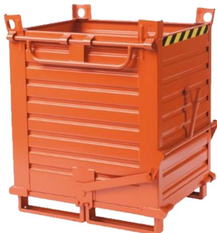
I contenitori in lamiera a fondo apribile sono particolarmente indicati per gli sfridi di medie dimensioni, agglomerati o trucioli. Il fondo apribile in due semiparti permette il rapido svuotamento del contenitore e riduce gli ingombri. È dotato di un blocco di sicurezza che evita l'azionamento involontario della leva di scarico.
