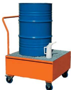
Le vasche di raccolta o contenimento carrellate sono studiate per agevolare gli spostamenti dei contenitori su essi posizionati grazie alle ruote sottostanti con diametro 200 mm. Sono realizzate in acciaio verniciato con grigliato d'appoggio superiore con maglie ad alta portata in acciaio zincato a caldo.
