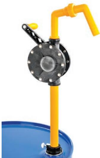
La **pompa rotativa** è adatta al trasferimento di liquidi chimici aggressivi, solventi clorurati e idrocarburi. Presenta un azionamento rotativo reversibile. Il tubo di pescaggio è diviso in tre sezioni ed è adatto a fusti da 210 litri.
