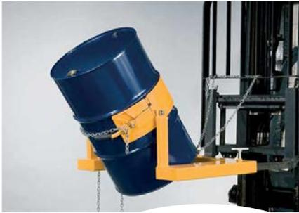
Il **ribaltatore inforcabile** permette il ribaltamento di fusti in ferro da 210lt, senza scendere dal mezzo che si utilizza, purché abbia delle forche con apertura massima 180 x 65 mm. Il ribaltamento del fusto avviene con una movimentazione a catena e dispone di chiusura si sicurezza con catena.
