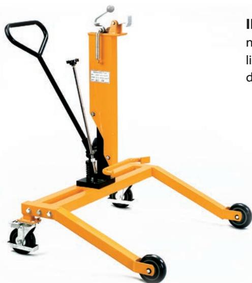
Il sollevafusti manuale con forche a novanta gradi permette la movimentazione e il posizionamento su bancali di fusti in ferro da 210 litri. È composto da due ruote fisse e una con freno. L'elevazione massima del fusto è pari a 30 centimetri.
