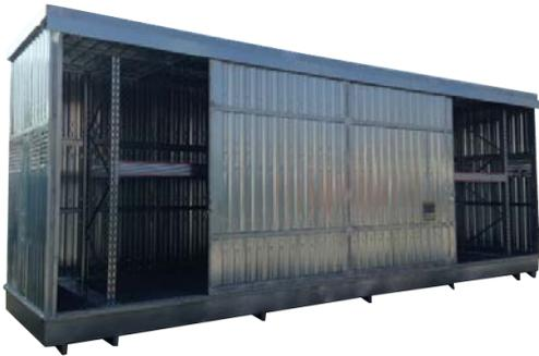
Il container in lamiera grecata zincata con vasca di contenimento interna è adatto allo stoccaggio di fusti in posizione verticale su uno o più piani d'appoggio su pallet 80 x 120 cm oppure 120 x 120 cm. È disponibile sia con porte a battente che con porte scorrevoli. All'interno della struttura sono presenti delle scaffalature in acciaio zincato fissate sul pavimento e regolabili in altezza.
