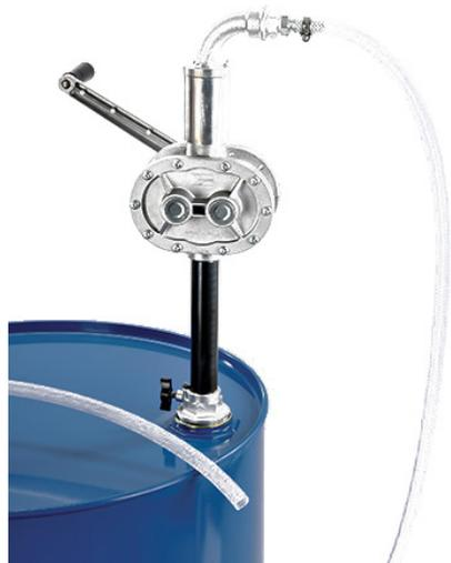
La **pompa rotativa** è adatta al trasferimento di carburanti, diesel, cherosene e oli idraulici. Presenta un azionamento rotativo reversibile. Il tubo di pescaggio è diviso in tre sezioni ed è adatto a fusti da 210 litri.
