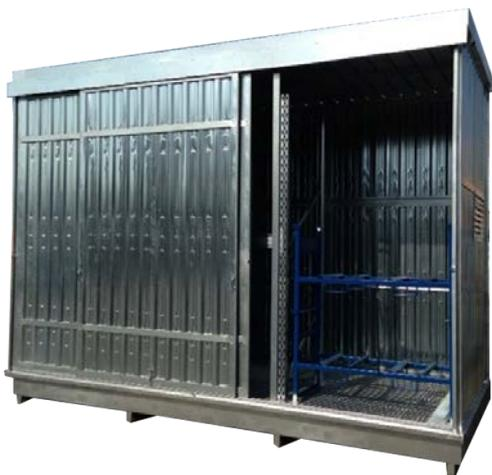
Il container in lamiera grecata zincata con vasca di contenimento interna è adatto a stoccare fusti in posizione orizzontale su diversi piani d'appoggio dotati di culle su cui posizionarli in sicurezza. È disponibile sia con porte a battente che con porte scorrevoli. All'interno della struttura sono presenti delle scaffalature in acciaio zincato fissate sul pavimento e regolabili in altezza per la sovrapposizione dei fusti.
